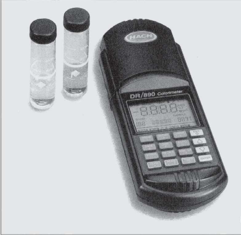
شكل 2-10: مقياس لوني محمول مع خلايا عينات لاختبار متحولات في الماء والتي يمكن قياس تراكيزها كميًا من خلال كثافة اللون في عينة الماء بعد معالجتها بالكواشف المحددة، (موافقة Hack Co Loveland, Co)
